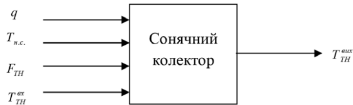
Рис. 1. Модель сонячного колектору як об'єкта керування: q - питомий потік інсоляції, поглинений колектором; T_{н.с.} - температура навколишнього середовища; F_{ТН} - витрати теплоносія через сонячний колектор; T_{ТН}^{ex} - температура теплоносія на вході сонячного колектору; T_{ТН}^{ex} - температура теплоносія на виході сонячного колектору.
