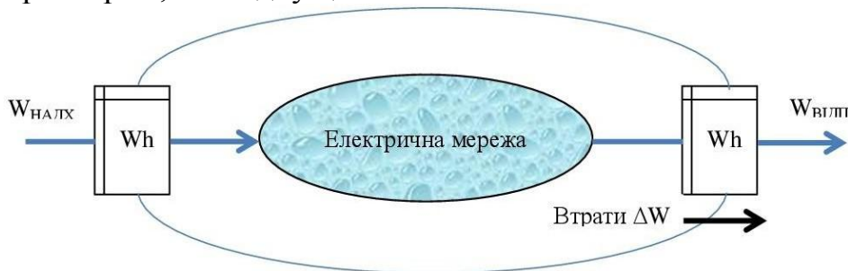
Рисунок 1- Баланс електроенергії в електричних мережах
