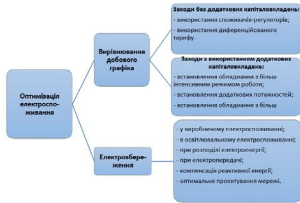
Рис. 1 – Структура енергоефективної системи електропостачання
