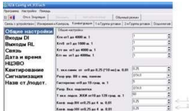
Рис. 2. Вибір параметрів диференційного захисту (коефіцієнт вирівнювання ВН - 1, коефіцієнт вирівнювання НН - 2), через програму «RZA_config»
