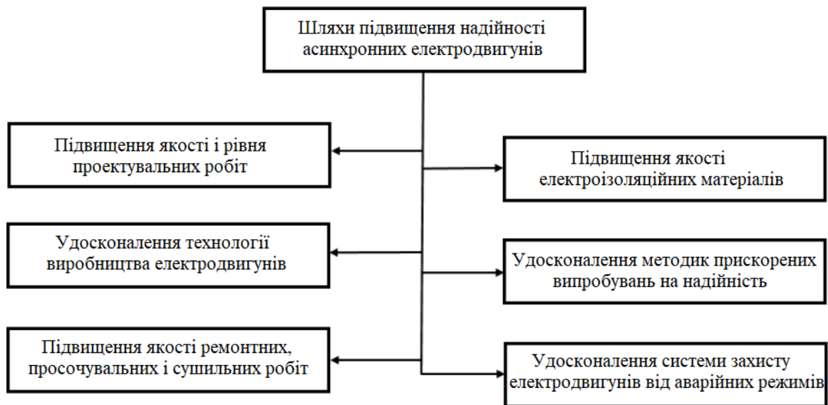
Рис. 1 – Шляхи підвищення надійності асинхронних електродвигунів
