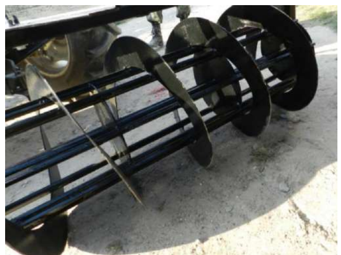
Рис. 2. Загальний вигляд робочої поверхні борони з гвинтовими робочими органами
