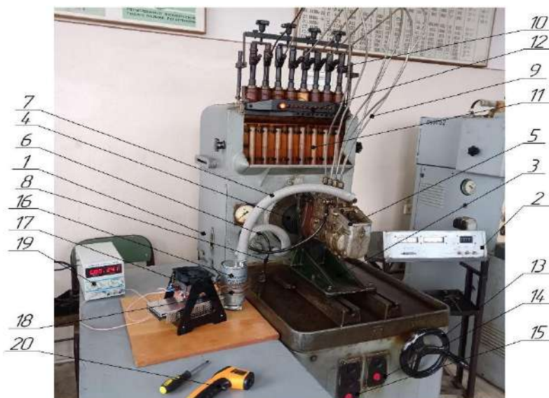
Рис. 2 Стенд для дослідження роботи паливної системи ДВЗ в умовах низьких температур:
