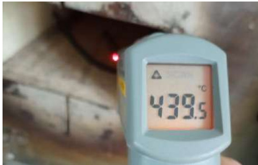
Рис. 1 – Термозагартування проводу Ni-Ti діаметром 0,9 мм
