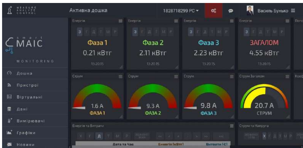
Рис. 2 – Візуалізація активної дошки «розумного лічильника»
