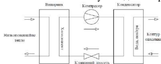
Рис.1 - Структурна схема роботи теплового насоса
