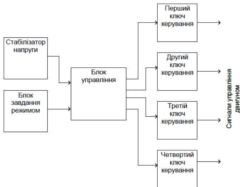
Рис. 1 – Структурна схема керування електродвигуном постійного струму
