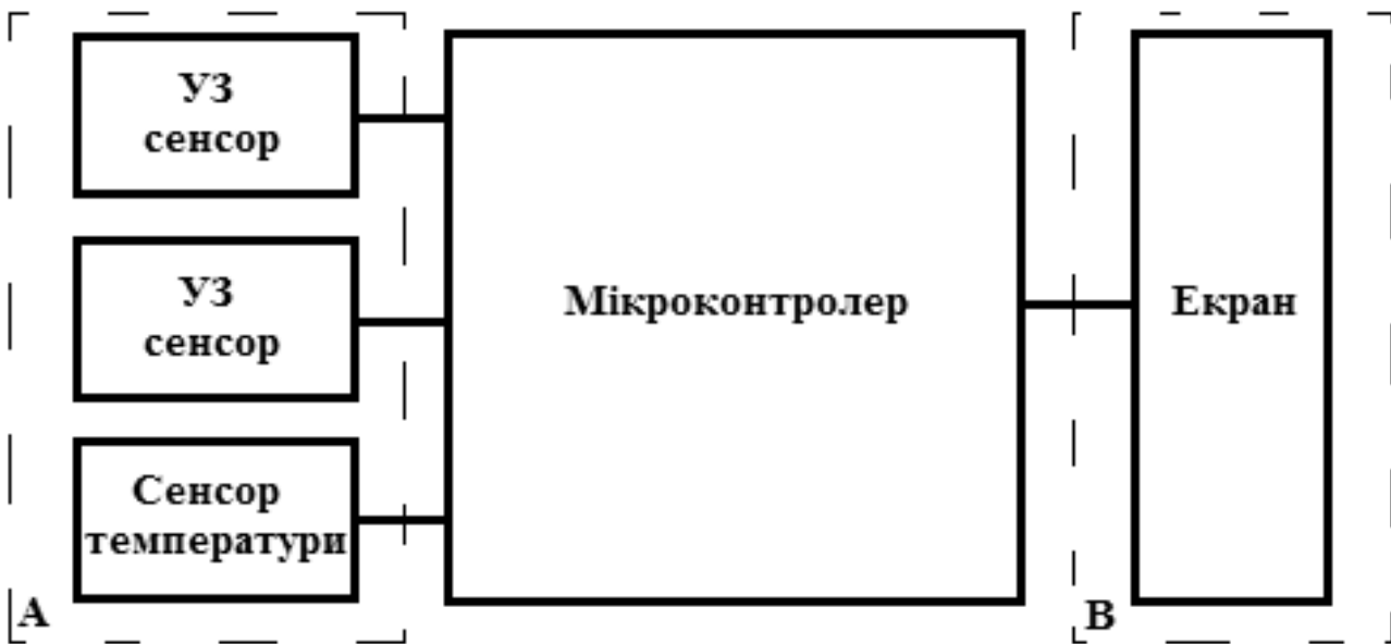
Рис.1 - Структурна схема мікроконтролерної системи
