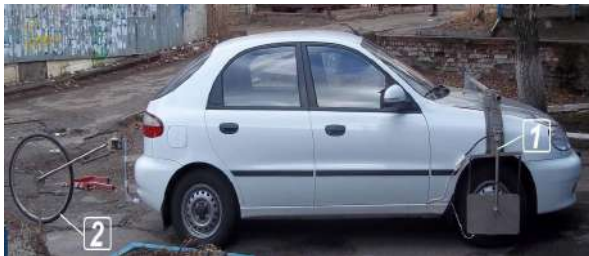
Рис.1. Загальний вид автомобіля з дослідницьким обладнанням 1 – датчик виміру кутів сходження коліс та їх повороту; 2 – «п'яте» колесо вимірювального комплексу
