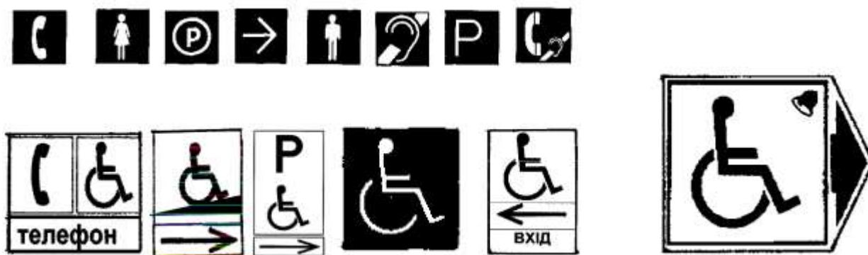
Рисунок 7.1 – Пиктограми та символи для візуальної інформації про розташування пристосованих для людей з інвалідністю місць та послуг
