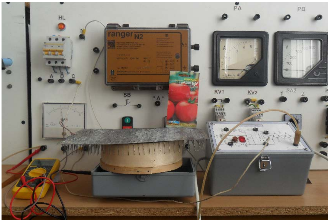
Рис. 6 - Зовнішній вигляд установки для обробки насіння електромагнітним полем високої напруги постійного струму.
