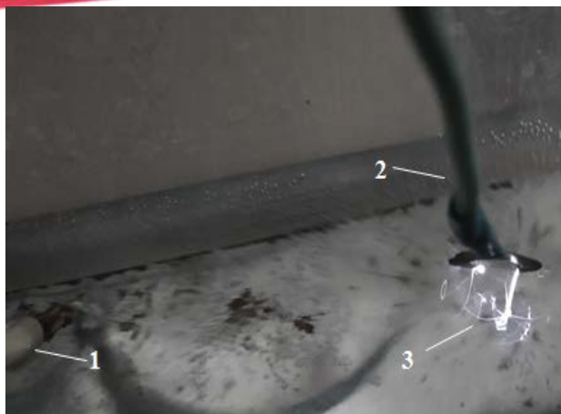
Рис.3 - Високовольтний розряд в повітряному прошарку між коронуючим і осаджуючим електродами
