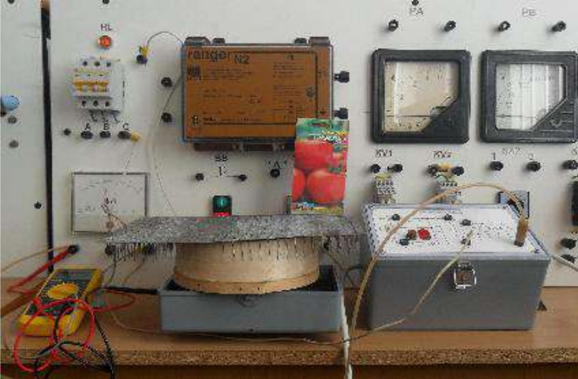
Зовнішній вигляд установки для обробки насіння електромагнітним полем високої напруги постійного струму
